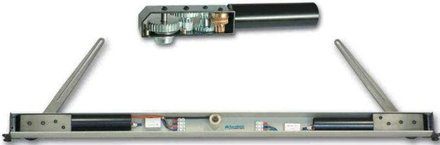
Il Serratore è costituito da due motoriduttori (230 Volt) con meccanica in acciaio esenti da manutenzione, assemblati internamente ad un cassonetto in alluminio estruso preverniciato.
